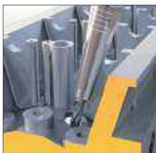
干渉のあるドリル加工 Drilling in tight space
